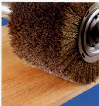
Tworzenie faktury powierzchni twardego drewna przy pomocy szczotek walcowych z wypełnieniem drucianym
