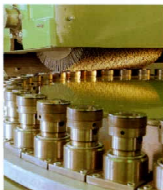
Szczotka walcowa z wypełnieniem typu ANS usuwa grat z płytek wielostronnych z węglików spiekanych na specjalnej maszynie do gratowania z okrągłym stołem
