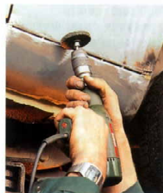
Szlifowanie spawu okrągłą szczotką trzpieniową typu Delta.
