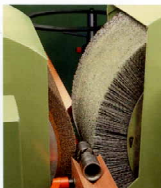
Bezłkowe gratowanie tłoka sterowniczego. Tutaj przy pomocy szczotki walcowej z wypełnieniem typu ANS.
