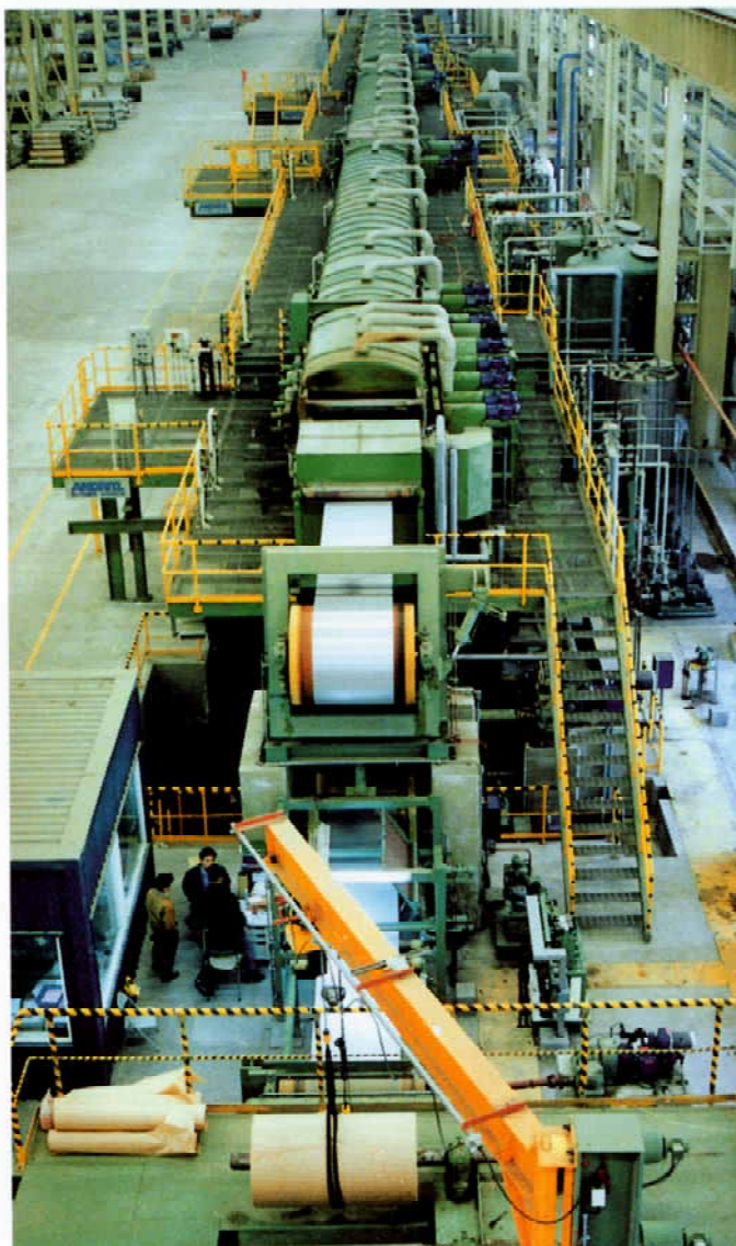
Linia wyżarzająco-trawiąca typu Conti do walcowania na gorąco taśm ze stali szlachetnych
